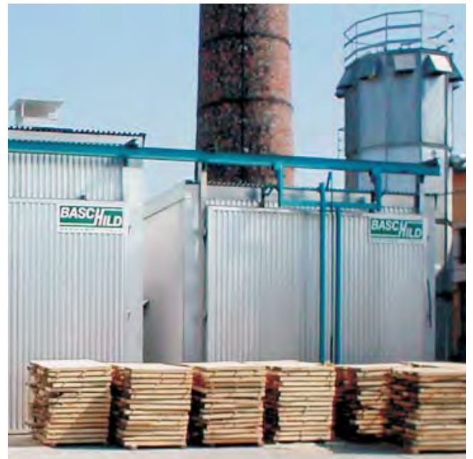
Пропарювальна ▼ камера прямого випаровування DVK-D (Албанія)
