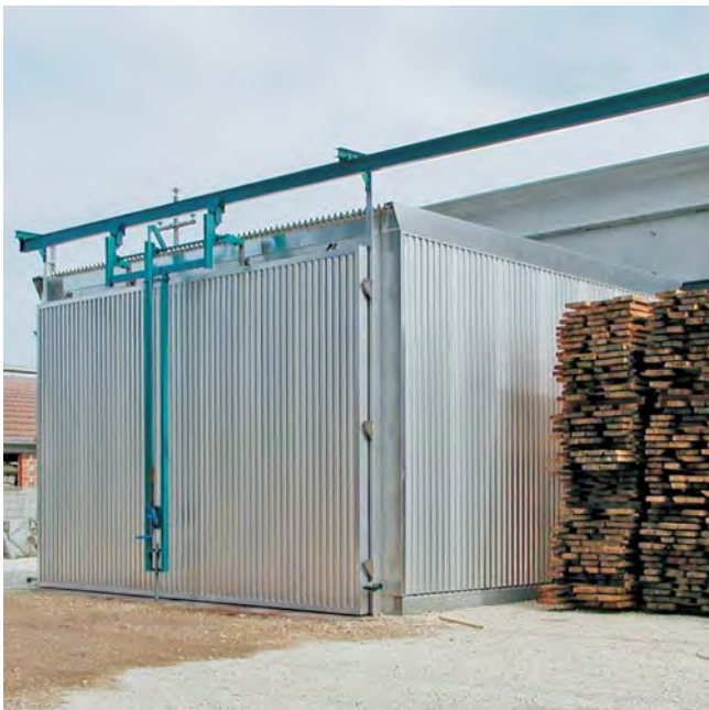
▼ Vaporizator DVK -I cu aburire indirecta prin gaz (Italia)
